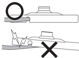
\* 電源コードは必ず切り込み部分から外側に出し、コードの上に電源プレートを載せないよう注意してください。
